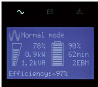
Intuitív LCD kijelző a könnyű konfigurálhatóság és kezelés érdekében
