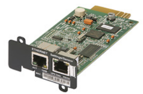
Választható Web/SNMP-kártya EMP-érezékelővel, külső akkumulátorszekrény vagy rack hőmérsékletméréséhez.
