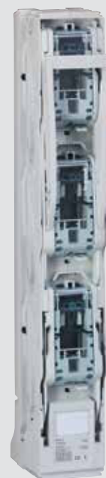
SPX 3 -V függőleges olvadóbiztosítós szakaszolókapcsoló: 4 méretben 160 és 630 A között (00, 1, 2, 3)
