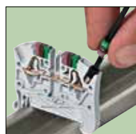
Tömör vagy érvég-hüvellyel ellátott hajlékony vezetékek szerszám nélkül csatlakoztathatók 6 mm osztástávolságig
